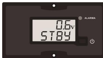
2. Modo 1 ~ 5, sin batería conectada
