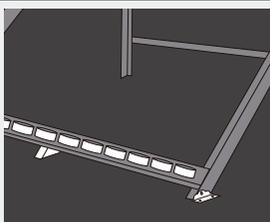
**P5.** Colocar los vasos inferiores, sin sus tapas a rosca (L) y las patas H e H\*.
