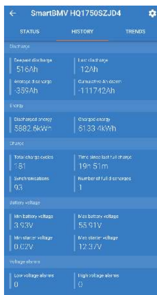
La aplicación VictronConnect mostrando el historial de un monitor de baterías BMV
