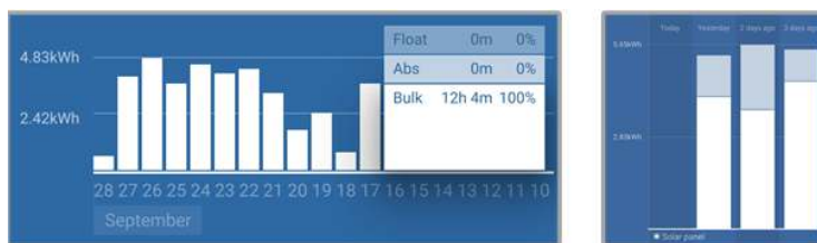
Sistema que pasa todo el tiempo en carga inicial con desglose de las fases de carga - Sistema en carga inicial y absorción
