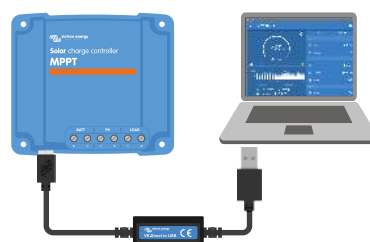
Conexión de la aplicación VictronConnect por USB con la interfaz VE.Direct USB
