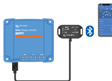
Conexión de la aplicación VictronConnect por Bluetooth con una mochila VE.Direct Bluetooth Smart.
