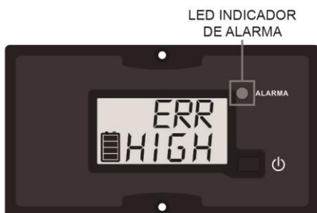
7. Protección por alto voltaje de batería
