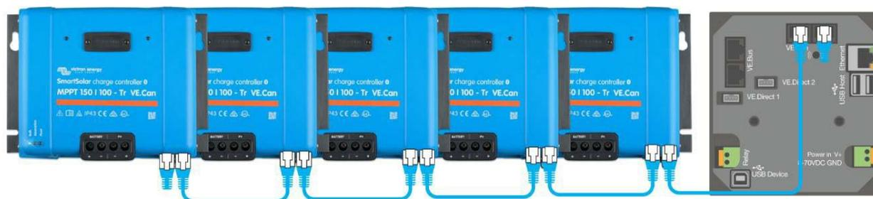
Con VE.Can o Bluetooth, pueden conectarse en cadena hasta 25 o hasta 10 controladores de carga respectivamente para carga sincronizada y conectarse a su vez a un Color Control GX o a otro dispositivo GX
