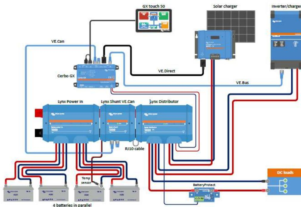
Sistema con Lynx Shunt VE.Can, baterías de plomo-ácido, un Lynx Shunt VE.Can y un distribuidor Lynx
